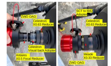
図 30: レデューサー組み合わせ例。左: \times 0.63 + \times 0.5 レデューサーの組合せ。右: \times 0.63 + \times 0.33 レデューサーの組合せ
